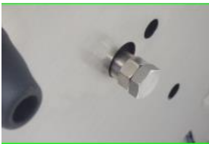
Сливная пробка в нижней части котла для облегчения удаления накипи из котла
